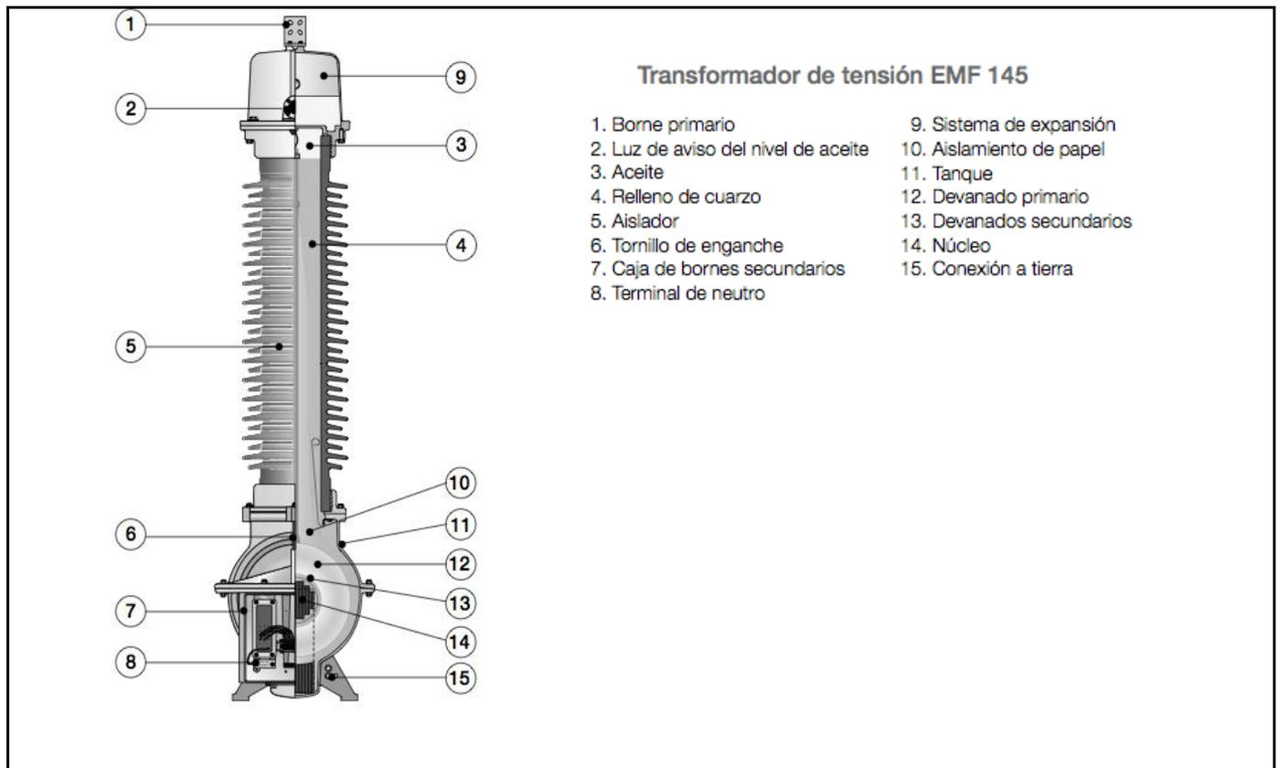
Figura 7. Transformador de tensión inductivo. Modelo EMF 14 de ABB (ABB Power technologies, 2005).
