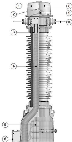
**Transformador de intensidad tipo IMB**
